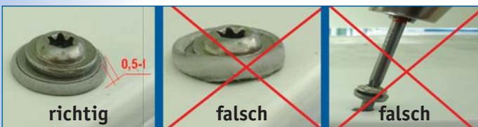
**Achtung:** Die Dichtscheibe darf sich nicht mehr als ca. 0,5 - 1 mm unter dem Schraubenkopf herausdrücken, damit die Dicht- funktion erhalten bleibt!
