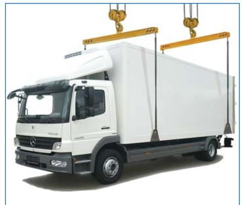
Heben Sie montierte Koffer niemals mit den Dachösen.
