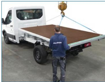
Die **Bodengruppe** setzen Sie **in einem Stück auf** anstatt die Komponenten für den Unterbau und den Boden mühsam zusammenzubauen. Für die Ladungssicherung gibt es eine **Airlineschiene serienmäßig!**
