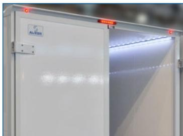
Bei der Elektrik bleibt der Lötcolben kalt! Sie erhalten das **genau zu Ihrem Fahrzeugtyp passende Adapterkabel**. Die Innenbeleuchtung, die 3. Bremsleuchte, die Seitenmarkierungs- und die Positionsleuchten sind vormontiert. Sie müssen diese nur mit dem Fahrzeug verbinden.
