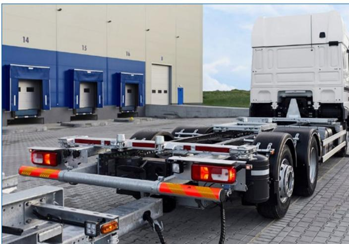
Die vorkonfektionierten Schneider BDF-Systeme **montieren Sie nur durch Verschrauben**. Mittels Doppelverriegelungen und / oder dem klappbaren Frontanschlag transportiert dabei das gleiche Fahrzeug **unterschiedlich lange Behälter**.
