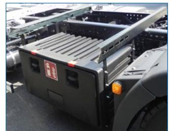
Schneider Wechselsysteme zeichnen sich durch eine lange Lebensdauer und die gleichbleibende funktionale wie optische Qualität aus. Maßgeblich sind hierfür die durchgehende Feuerverzinkung sowie der Einsatz großer Materialstärken.
