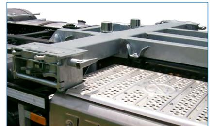
Schneider BDF-Holme decken die üblichen Behälterlängen und **bis zu 3 Abstellhöhen von 1.020 - 1.220 mm bzw. 1.120 - 1.320 mm** ab. Sie erhalten diese auf Wunsch mit integrierten oder angeschweißten Einweisrollen.
