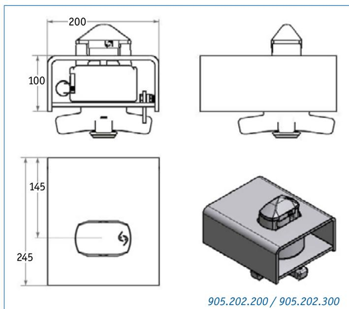
Die **von innen bedienbare Nutenbuchse** erlaubt einen durchgehenden Außenrahmen. Weitere Verriegelungen sowie mehr Informationen zur Containertechnik finden Sie unter [www.schneider-fc.com](http://www.schneider-fc.com).
