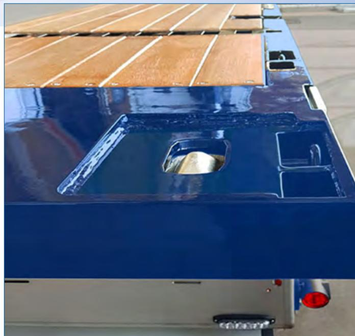
**Alle unsere Verriegelungen** erhalten Sie **mit verzinkten Innenteilen** für einen optimierten Schutz gegen Korrosion. Die **Gehäuse der Verriegelungen** erhalten Sie roh für eine klassische Lackierung **optional auch in feuerverzinkt**.
