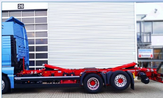
Im Sortiment der **starrten Holme** mit Einzel oder Doppelverriegelungen **kommt der abgebildete Holm für den fahrerhausbündigen Transport unterschiedlicher Behälterlängen neu hinzu:**
