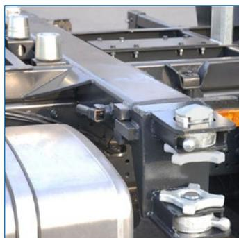
Zu den **höhenverstellbaren Holmen** gehören drei **Lift-lockausführungen**, sowie unzählige **drehbare Varianten**, die wir Ihnen, zugeschnitten auf den Anwendungsfall, konfigurieren.
