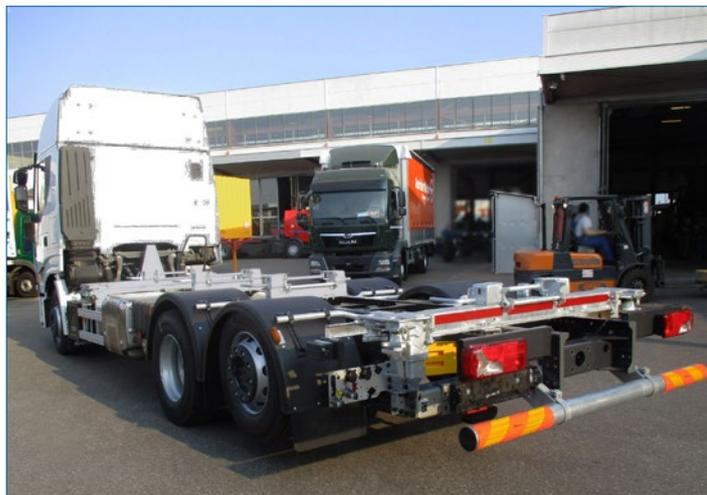
BDF-Systeme von Schneider **montieren Sie ohne Schweißarbeiten** einfach durch Verschrauben. Zur Gewichtsoptimierung verbinden Sie alle Komponenten, ohne Hilfsrahmen direkt mit dem Fahrgestell.
