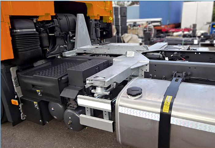
**Verschleißauflagen** verhindern den Kontakt (Abrieb des Lacks) von Wechselbrücke und Chassis.
