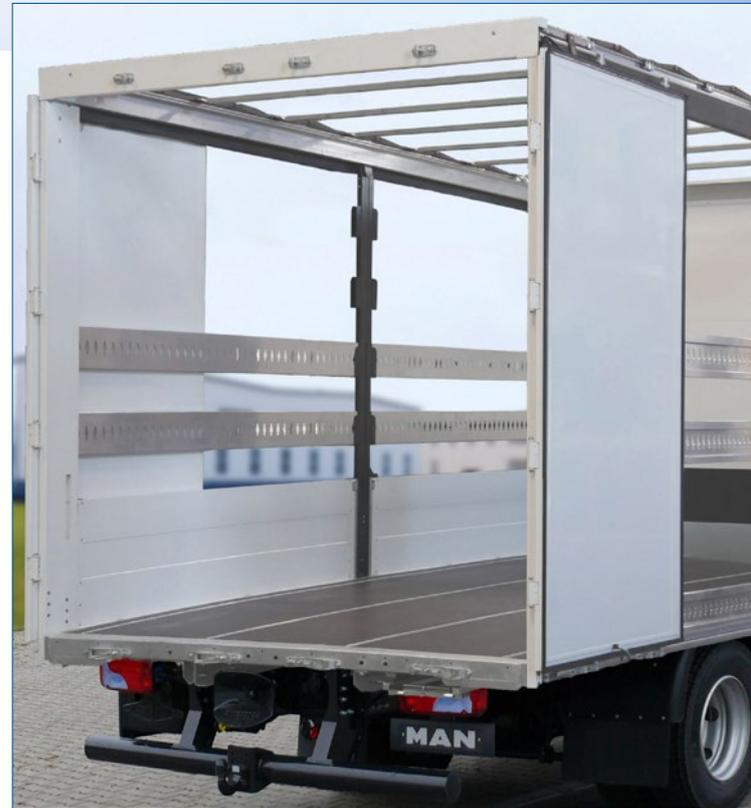
Last but not least haben Sie zudem die Möglichkeit, den **Bausatz mit Einsteckplatten** in verschiedenen Ausführungen sowie mit einer **Bordwand inklusive Planensicke** zu bestellen.
