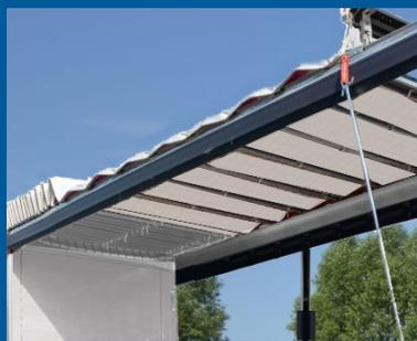
Für **Ladebordwände** erhalten Sie die bei den Kofferbausätzen bewährten Oberklappen mit integrierter Dichtung. Beim **Festdach** erfolgt deren Befestigung am Türportal, bei einem **Schiebedach** in der Bauform der mitlaufenden (verschiebbaren) Aufstellklappe.
