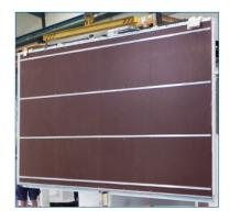
Die vormontierte Bodengruppe, die Basis des Kits, besteht aus dem Unterbau mit eingelegten Bodenplatten. Diese verfügen entweder über die klassischen Siebdruck-, Aluminium-Gerstenkorn-, Aluminium-Längsrillen- oder GFK-AntiSlip-Oberflächen.
