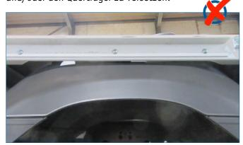
Diese Arbeiten vermeiden Sie nun. Mit der Auswahl der Längsträger - wahlweise in 120, 140 oder 160 mm Bauhöhe erstellen Sie einen optimal an das Chassis angepassten Curtainsider mit minimalem Aufwand!
