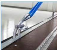
Besonders praktisch für die Sicherung der Ladung sind die **versenkten Zurrbügel im Außenrahmen**. Weitere Bügel sind bei Bedarf möglich. Zudem gibt es optional in Längsrichtung **Airline-schienen im Boden** und ggf. an den Dachspriegeln.
