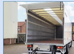
Bei Bedarf sind **Airlineschienen im Boden** (z.B. GFK-Anti-Slip-Oberfläche) und den Wänden schon montiert.
