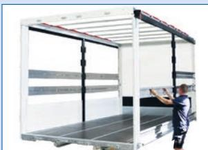
Die **Sicherheitseinsteckklatten** mit Kombi-Ankeschienenlochung sind für Sperr- oder Doppelstockbalken wie Zurrgurte **multifunktional verwendbar**.
