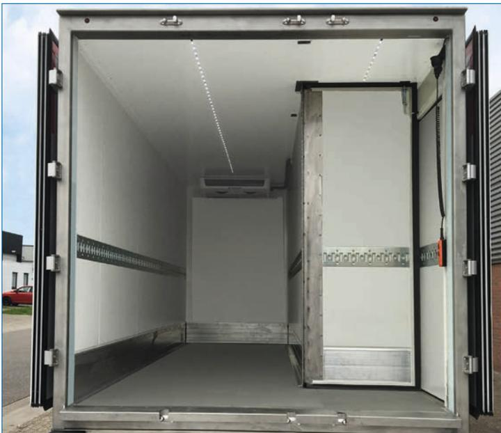
Mit den flächenbündig eingelassenen Scheuerleisten der FerroFoam-Kits gewinnen Sie wenigstens 12 mm Innenbreite, bei einer Längstrennwand sogar 24 mm.
