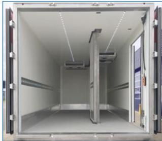
Sie erhalten ferner AluTeam-**Türen und Klappen** eingebaut in ein Paneel, um es als Seiten- oder Trennwand zu verwenden.
