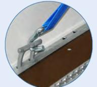
Die Stirnwand verfügt über zwei Zurrpunkte. Durch eine Zusatzoption in den Eckungen können Sie **weitere Verzurrmöglichkeiten** schaffen.
