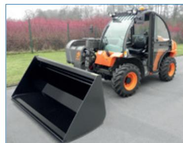
Die **verschraubte Lochplattenaufnahme** ist für alle gängigen Frontlader, Rad-, Teleskop- oder Hofladeraufnahmen erhältlich. Damit ist auch später ein Wechsel des Trägerfahrzeugs leicht möglich.
