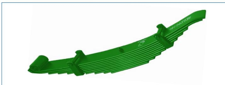
Die **Trapezfeder** ist robust, kostengünstig und reparaturfreundlich. Die einzelnen Federlagen sind über die gesamte Länge gleich stark und berühren sich, wodurch eine **gute Eigendämpfung** entsteht.
