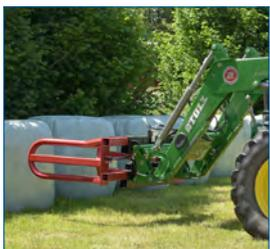
Dickwandige, stabile Stahlrohrame schmiegen sich schonend mit **sicherem Griff** an die verschiedenen Ballenformen. Trotz hoher Haltekräfte **wird eine Überdehnung oder Beschädigung von Silagefolien vermieden.**
