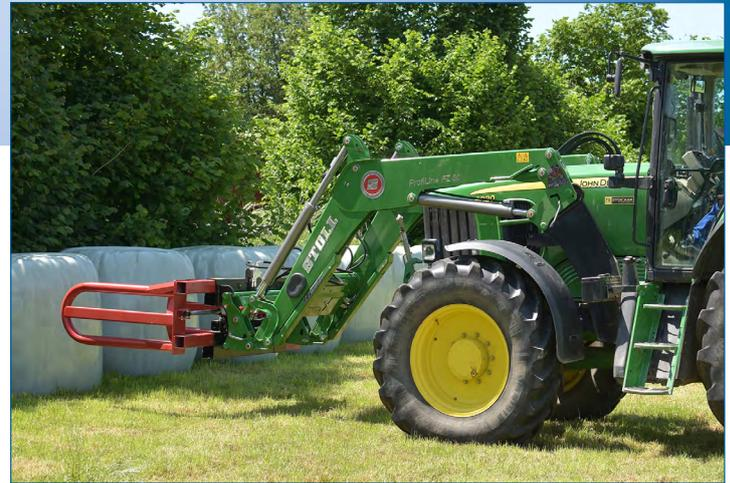
Auch die **Rundballenzange** ( $\varnothing$  900 bis 1.500 mm) mit einem **Hydraulikzylinder** gewährleistet durch den **Druckausgleich** und **gerundete Greifarme** einen sicheren Griff der Ballen.
