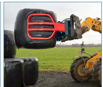
Die **Quaderballenzange** packt Ballen von 800 bis 2.000 mm. **Zwei 180 bar - Hydraulikzylinder** bewirken eine hohe Haltekraft. **Dickwandige Stahlrohrarme** schmiegen sich schonend an die verschiedenen Ballenformen. Eine Überdehnung oder Beschädigung der Silagefolie wird durch den **gleichmäßig verteilten Druck** vermieden.
