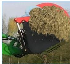
Durch die **hohe Öffnungsweite** lässt sich die Schaufel bei geöffnetem Greifer dicht an eine Wand heranfahren. Der geschlossene, hohe Schaufelkörper minimiert dabei Bröckelverluste bei der Entnahme von Maissilage.
