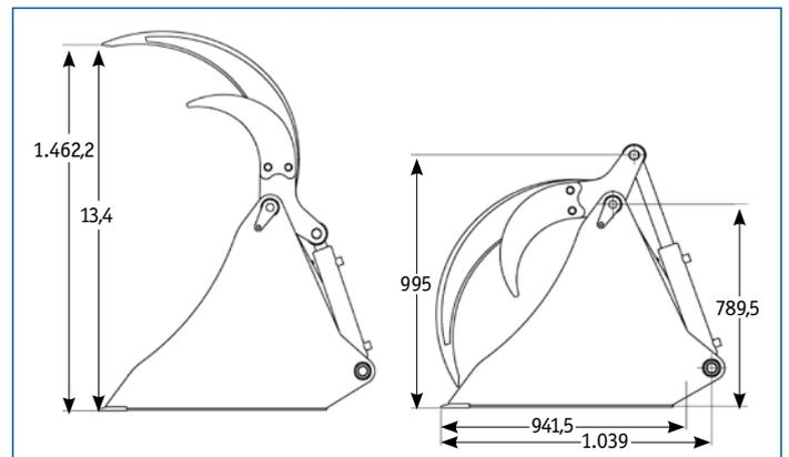
Die **Silageschaufeln** bieten einen günstigen Schwerpunkt, dicht am Schlepper. Zwei hochwertige Hydraulikzylinder sorgen für einen gleichmäßigen, starken Druck der Oberzange.
