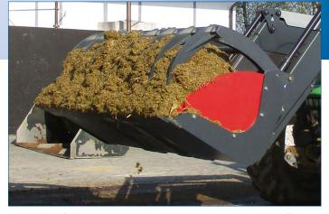
Die Schaufeln werden nach vorn durch eine Schürfkante (500 HB) verstärkt und verfügen an der Unterseite über Gleitkufen. Abnehmbare Seitenbleche vermeiden den Verlust von Ladegut. Die hohe Öffnungsweite über die Schaufelkante hinaus erlaubt es, bei geöffnetem Greifer an eine Wand heranzufahren. Als Hydraulikanschluss fungiert der bewährte Stecker BG3.
