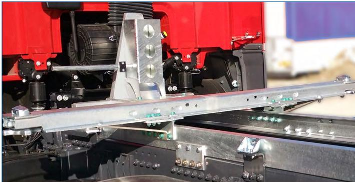
Die **Mittenaufgabe** aus zwei Distanzträgern gibt es, wie alle anderen Baugruppen, passend für die jeweilige Systemhöhe. Sie erhalten angepasste Komponenten oder zusätzliche Höhenadapter. Bei Höhenverstellungen gibt es zusätzlich eine klappbare Mittenunterstützung.
