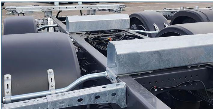
Die **Querträger** verbinden sich über Konsolen mit dem Chassis. Sie tragen die bewährten Schneider-Verriegelungen sowie die Einweisrollen.
