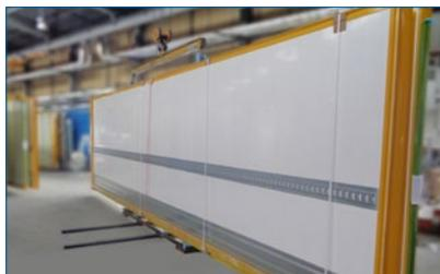
Sichern Sie den Bausatz z.B. mittels mind. 3 m langer eingelegter Rechteckrohre (80×60×3 o. 80×60×4 mm), die den Fuß des Transportgestells in der Höhe vollständig ausfüllen.
