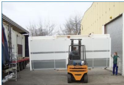
Setzen Sie den Bausatz ab, entfernen den Distanzhalter und schieben die Staplerzinken vollständig ein.
